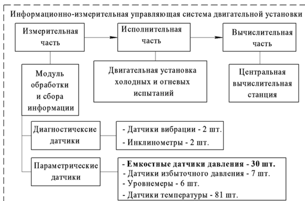
Рис. 1. Блок-схема ИИУС двигательной установки
